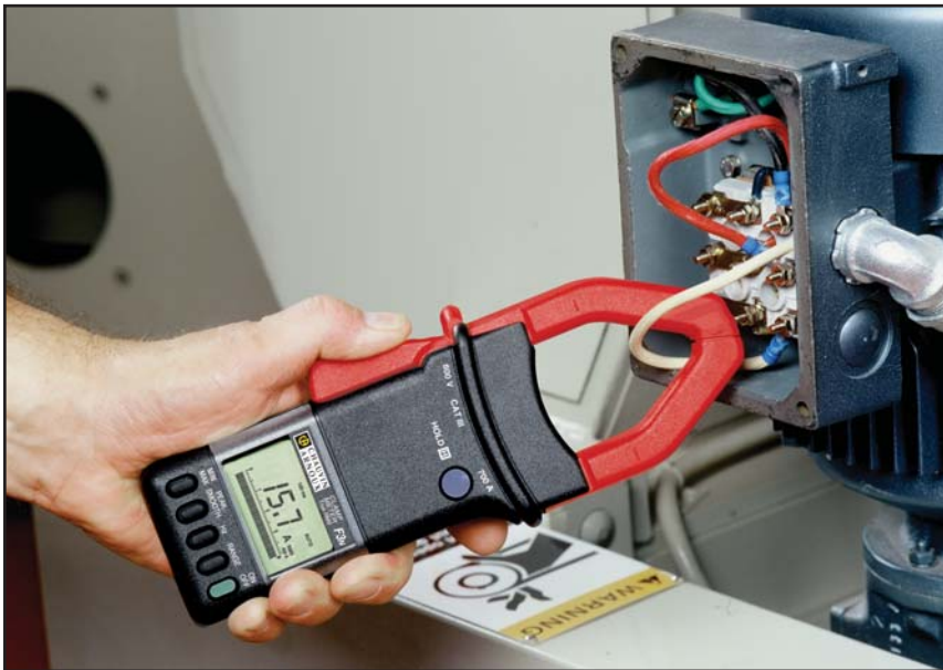
Modelo F3N midiendo corriente de fase en un motor de 3 fases.
