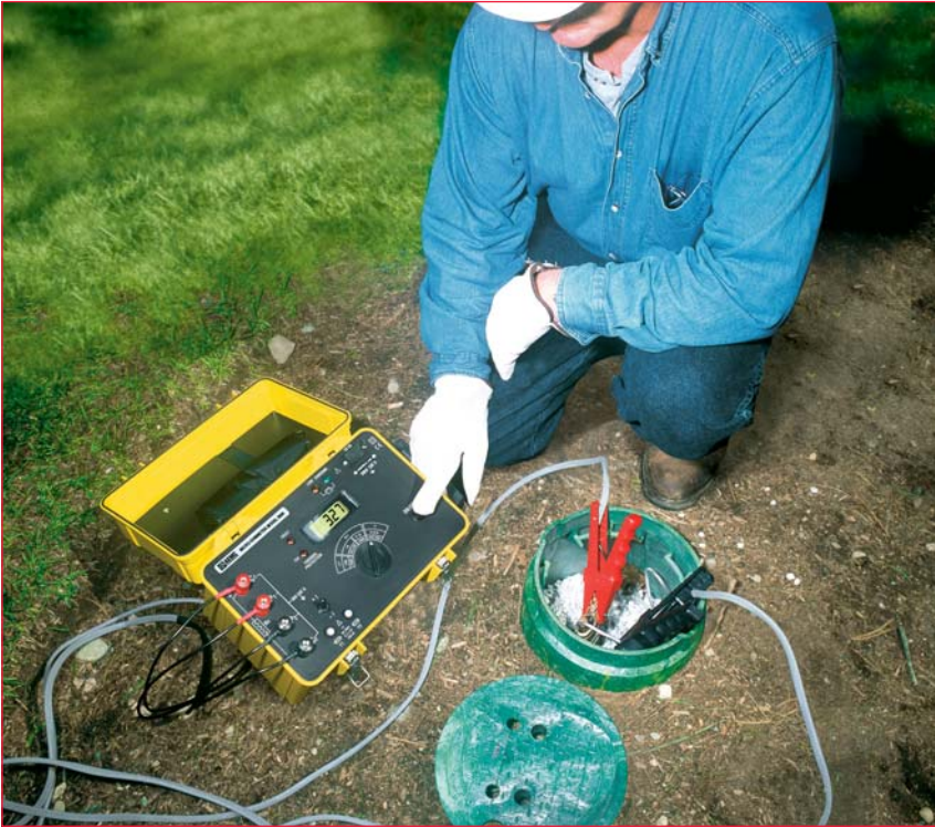
Modelo 5600 utilizado para comprobar la resistencia bonding, en una conexión de un sistema de toma de tierra.
