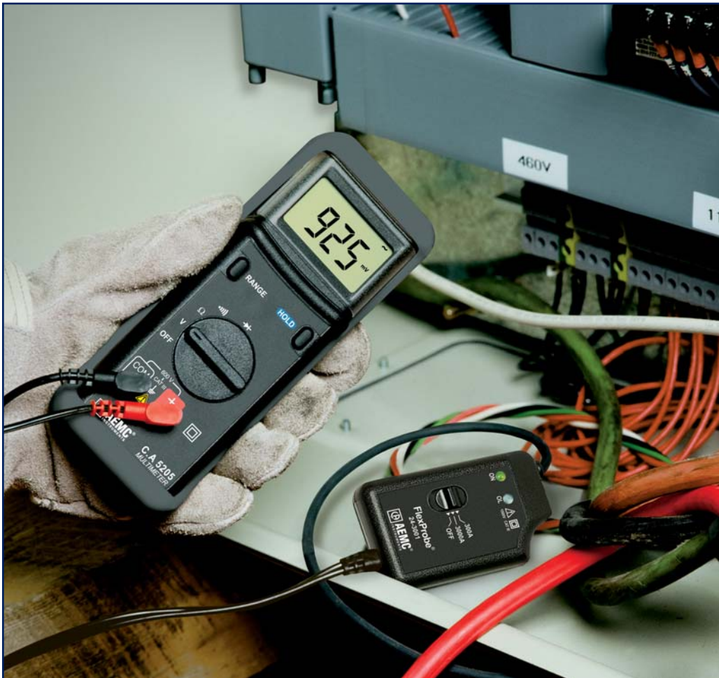
El FlexProbe® se conecta convenientemente en la entrada de voltaje estándar del DMM para una lectura directa de la corriente medida.
