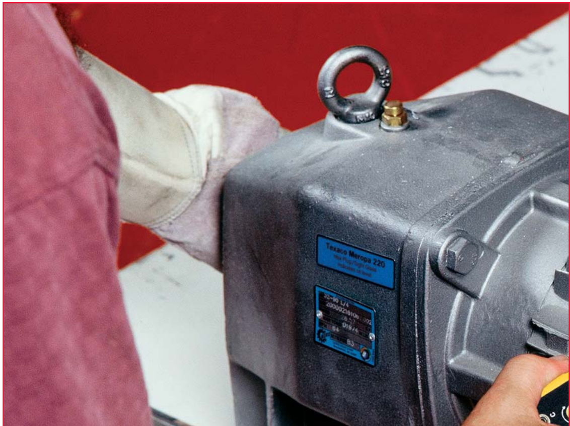
Modelo PMR-1 verificando la rotación del motor.
