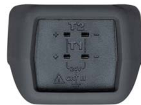
El Modelo CA863 posee dos entradas para termopar tipo K para realizar medidas diferenciales
