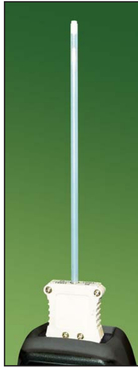
El Modelo CA865 se suministra con un sensor RTD para medidas de precisión
