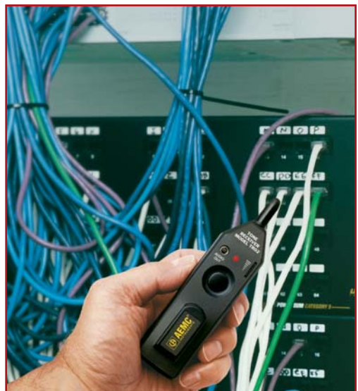
Modelo TR02 encuentra cables en paneles.
