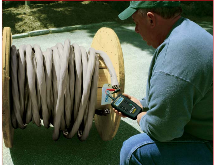
Modelo CA7024 comprobando la longitud de un cable eléctrico en un rollo.
