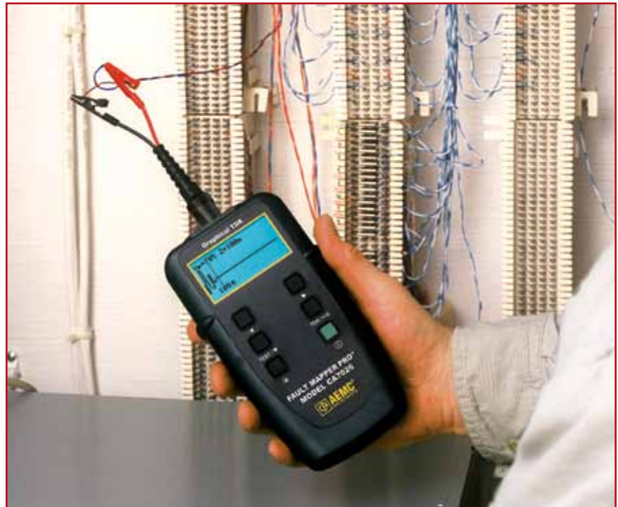
Modelo CA7026 comprobando cables en un panel telefonico
