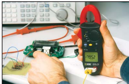
Modelo F03 midiendo la temperatura en un circuito eléctrico utilizando un termopar.
