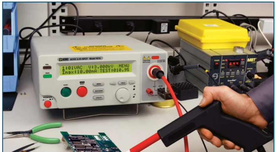
Modelo H216 efectuando un prueba de fuga (leakage), con una pistola para pruebas de alto voltaje (HV) opcional.
