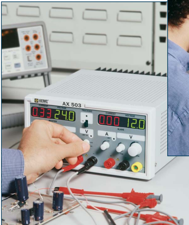
Ensayo de diseño de placa de circuito usando las salidas de 30V y 5Vcc
