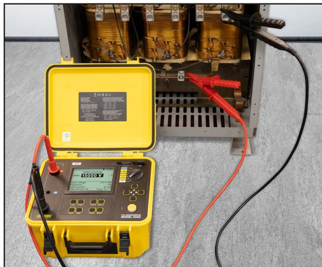
Modèle 6555 effectuant un test monophasé sur un transformateur triphasé.
