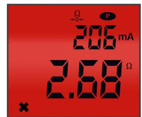
3. À chaque nouvelle mesure, l'instrument indique la différence entre la nouvelle lecture et la mesure de référence, ainsi que la différence en %.
