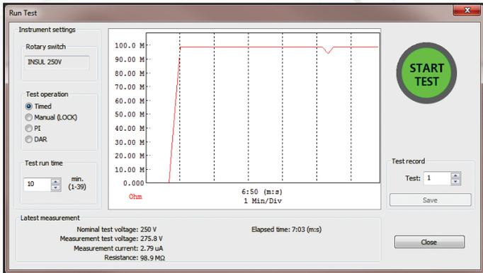
Sélectionnez les conditions de test et lancez un test à partir du PC et affichez les résultats de mesure en temps réel sous forme graphique.
