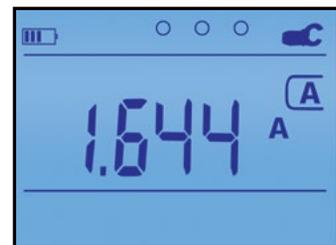
La corriente de fuga se muestra cuando la pinza opcional MN72 se conecta y la función V/A está seleccionada (modelo 6424)
