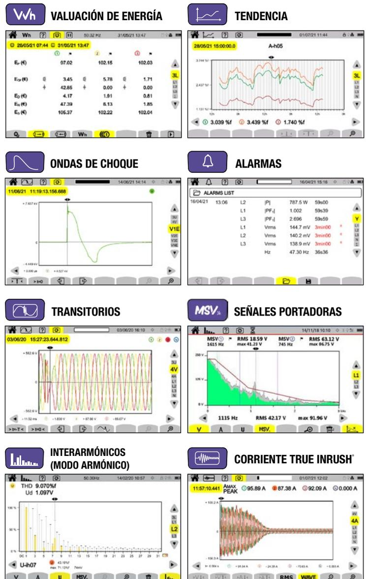
Incluye software DataView® GRATIS para configuración, descarga de datos, visualización en tiempo real, análisis y generación de informes
