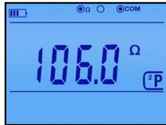
El modo de 2 puntos, utilizado para verificación de continuidad y de uniones, está activo al encender el instrumento
