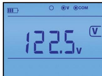
La tensión activa se muestra cuando la función V/A está seleccionada y los cables de prueba están conectados a una tensión CA o CC (modelo 6424)
