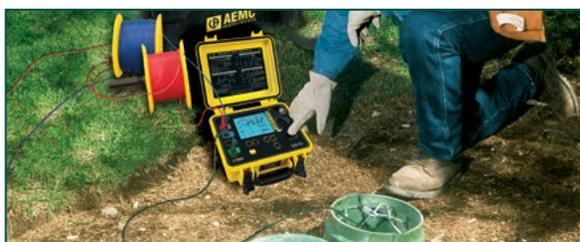
El modelo 6472 provee una medición automática del valor de resistencia de tierra usando el método de caída de potencial y almacenamiento de mediciones.
