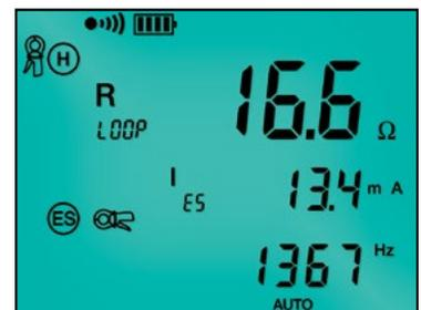
La prueba con el método de doble pinza muestra la resistencia de la conexión de las pinzas, la corriente de prueba y frecuencia.
