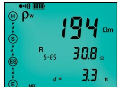
La prueba de Wenner muestra la conexión de los cables de prueba, los resultados de la prueba de resistividad del suelo ( $\rho$ ), la separación entre electrodos y la resistencia.
