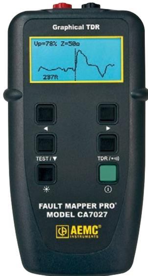
Fault Mapper Pro Probador de Cable Telefónico / TDR Gráfico
