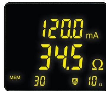
Indica el umbral de la alarma de corriente o tensión junto con la dirección de impedancia
