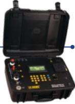
**10** Medición de resistencia de contacto de conexiones atornilladas
