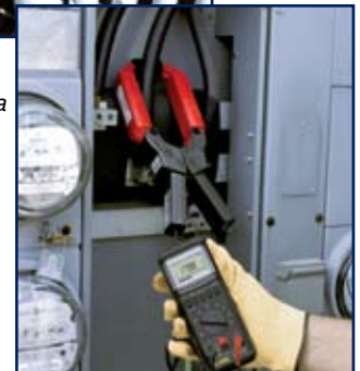
Modelo JM810A midiendo la corriente sobre un circuito de la rama principal.
