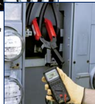
Modelo JM810A midiendo la corriente sobre un circuito de la rama principal.
