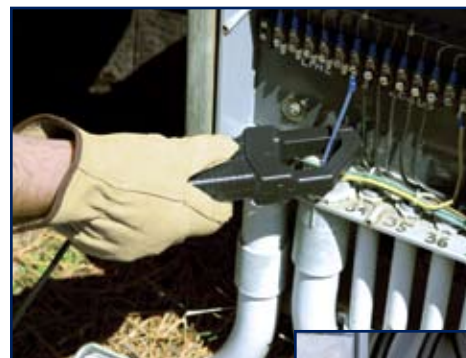
Modelo MD301 midiendo la corriente de corriente alterna sobre un alimentador.
