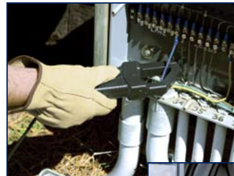
Modelo MD301 midiendo la corriente de corriente alterna sobre un alimentador.
