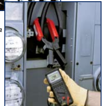
Modelo JM810A midiendo la corriente sobre un circuito de la rama principal.
