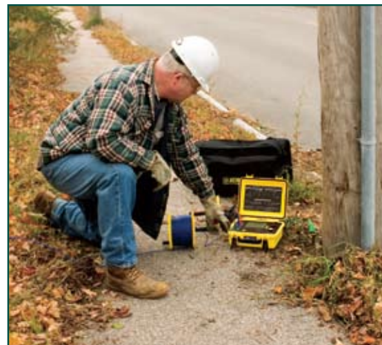
El modelo 6470-B comprueba rápidamente la resistencia de la jabalina de tierra ¡con tan sólo conectar, presionar y leer!
