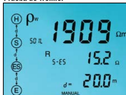
La prueba de Wenner muestra la conexión del cable de prueba, los resultados de la prueba de resistividad del suelo ( \rho ) y la distancia y resistencia entre los electrodos.
