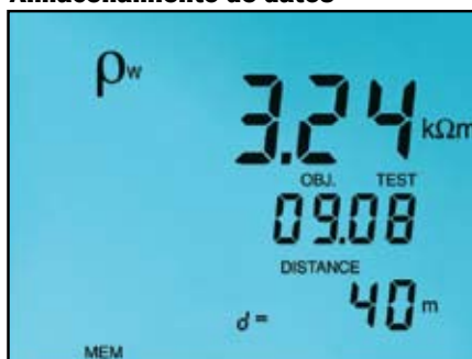
Muestra los resultados de prueba almacenados en una ubicación específica de la memoria al igual que la función de prueba.
