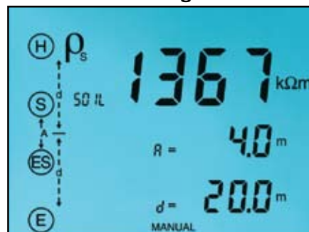
La prueba de Schlumberger muestra la conexión del cable de prueba, los resultados de la prueba de resistividad del suelo ( \rho ) y la distancia entre los electrodos.
