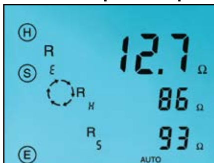
La prueba de caída de potencial de 3 puntos muestra la conexión del cable de prueba, la resistencia de la jabalina de tierra y las resistencias del electrodo de prueba.
