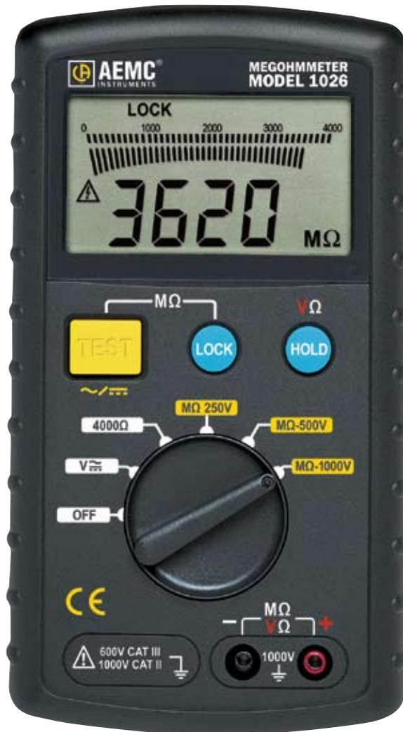
El Megóhmetro Digital Modelo 1026 es un megóhmetro digital compacto, ligero y funciona con pilas. Es un Megóhmetro que le proporciona cuatro pruebas funcionales: Voltímetro CC, voltímetro CA, ohmetro y comprobador de continuidad. El Modelo 1026 prueba a 250V, 500V y 1000V, y mide resistencia de aislamiento desde 1kΩ hasta 4000MΩ.
