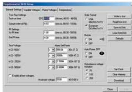
Cuatro opciones de ventanas con fichas que permiten configurar fácilmente las funciones del modelo 5070, incluyendo la configuración de tensión variable y puntos establecidos de alarma, como también pruebas de incremento de tensión y compensación de temperatura.
