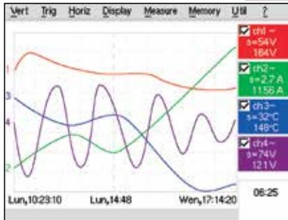
El serie OX<sup>III</sup> es compatible con una gran variedad de sensores (tensión, corriente, temperatura, 0 a 10 V, 4 a 20 mA, etc.) y los presenta en sus unidades y escala física original.
