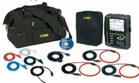
Todos los modelos contienen tres sondas amperimétricas identificadas por colores, con cables de 3 m (10 pies) (se muestra como ejemplo la versión AmpFlex®), cuatro cables de tensión de 3 m (10 pies) identificados por colores, cuatro terminales tipo cocodrilo identificados por colores, cable serial con acoplamiento óptico RS-232 DB9H, batería de NiMH, cable de alimentación de 120 V (USA), software DataView®, bolsa portátil, bolsa portátil suave y manual del usuario.
