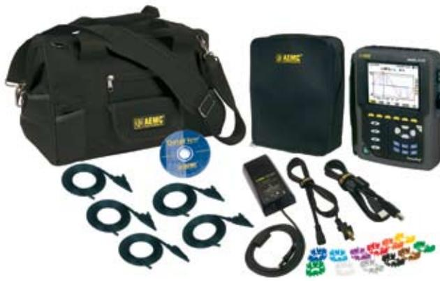
Todos los modelos contienen cinco conductores de tensión negros de 3 m (10 pies), cinco terminales tipo cocodrilo negras, doce anillos identificados por colores, cable USB, batería de NiMH, adaptador de corriente de 110/240 V con cable de alimentación de 115 V (USA), software DataView®, bolsa de herramientas clásica grande, bolsa portátil y manual del usuario.
