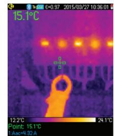
Muestra el valor en el cursor. El cursor se puede desplazar utilizando las teclas de navegación.
