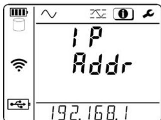
**L'adresse IP** est l'adresse utilisée par l'ordinateur lors de la connexion à l'instrument via Wi-Fi via le routeur. L'adresse complète défile de droite à gauche en bas de l'écran, suivie du numéro de port et du protocole de communication (UDP ou TCP)
