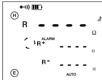
El instrumento efectúa una medida con una corriente positiva (R+), luego invierte el sentido de la corriente y efectúa una nueva medida (R-).
