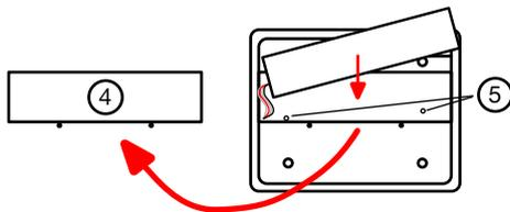
5. Saque la batería ligeramente de su alojamiento, sin ejercer ninguna fuerza sobre los hilos, para poder aflojar los dos tornillos situados en el fondo del alojamiento de la batería. Luego, vuélvala a poner en su sitio.
