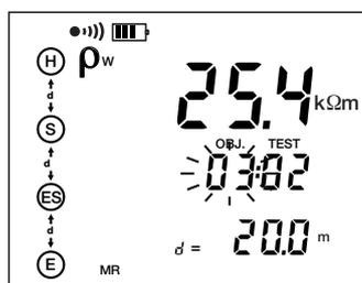
La tecla ▲▼ permite modificar lo que parpadea y la tecla ► permite seleccionar lo que desea cambiar: OBJ, TEST o el tercer criterio de direccionamiento (la distancia en el ejemplo de la izquierda).
