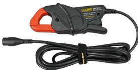
(1) Sonda amperimétrica
