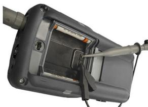
Conecte la sonda que se va a ajustar a la salida de la calibración que está debajo de la tapa del compartimento de la batería, como se muestra en la imagen a la izquierda.
