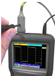
En este ejemplo la sonda está sobrecompensada, por lo que se muestra un rebasamiento.
