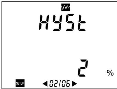
Figure 48 : Affichage du paramètre relatif à l'hystérésis.
