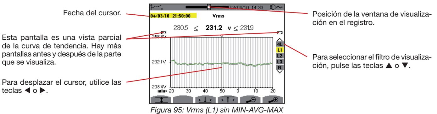
Para cada una de las fases (L1, L2 y L3), a cada registro de un valor en un segundo (período de registro), el instrumento registra también el valor RMS semi-período mínimo para un segundo y el valor RMS semi-período máximo para un segundo. Estas tres curvas son las representadas en la figura más arriba.
