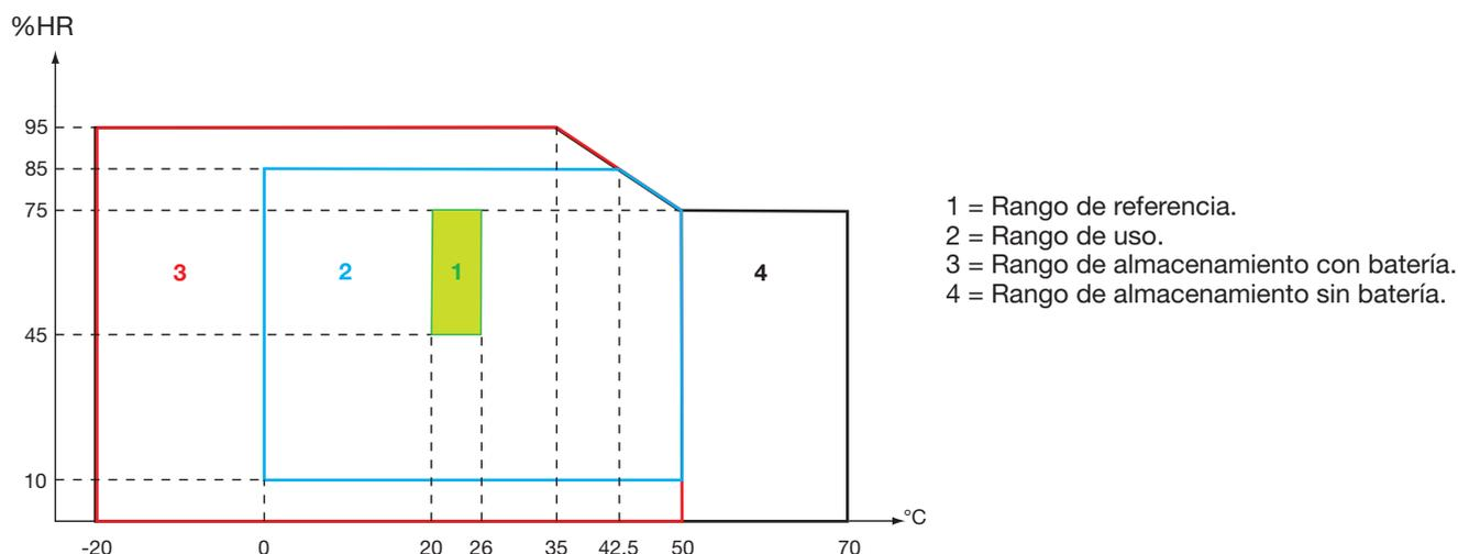
**Atención:** por encima de los 40 °C, el instrumento debe utilizarse sólo con la batería **O** sólo con un adaptador de red eléctrica. El uso del instrumento con simultáneamente la batería **Y** el adaptador de red eléctrica externo específico está **prohibido**.
