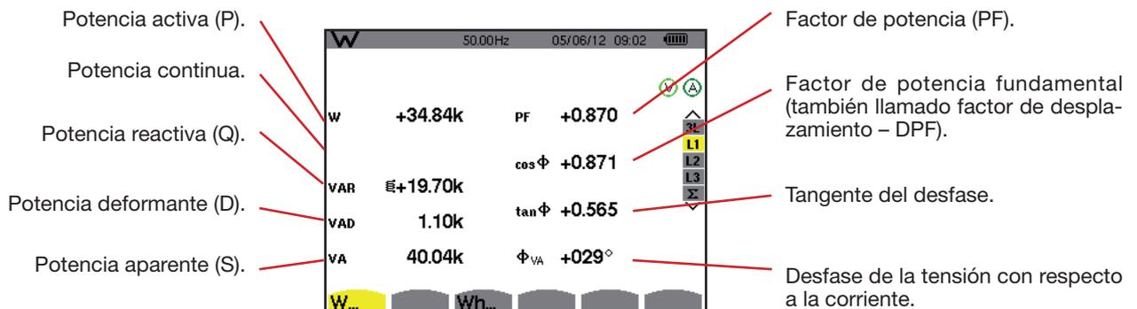
Figura 113: la pantalla de visualización de las potencias y magnitudes asociadas en L1
