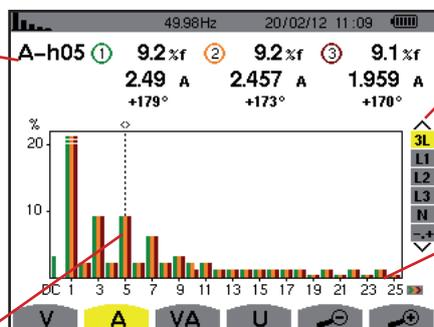
Visualización de las 3 fases 3L, de L1, L2, L3, N o del modo experto (conexión trifásica únicamente – véase § 6.5). Para seleccionar la visualización, pulse las teclas  $\blacktriangle$  o  $\blacktriangledown$ .
