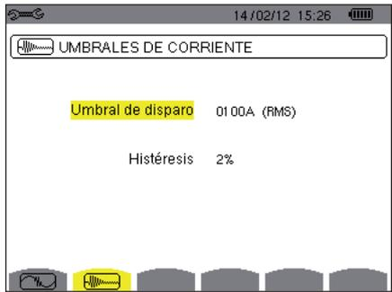
Figura 30: la pantalla Umbrales de corriente de inserción en el menú Modo corriente de inserción
