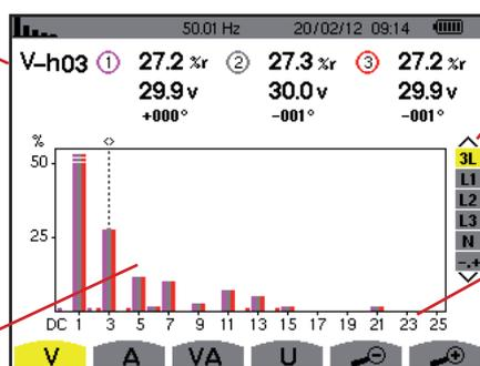
Visualización de las 3 fases 3L, de L1, L2, L3, N o del modo experto (conexión trifásica únicamente – véase § 6.5). Para seleccionar la visualización, pulse las teclas ▲ o ▼.
