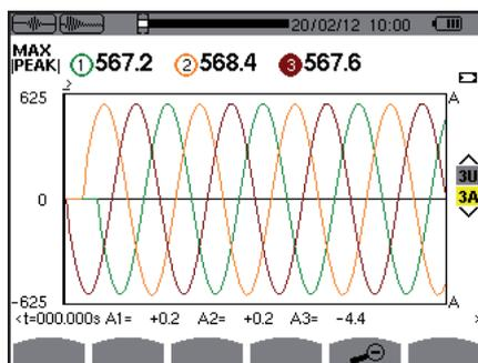
Figura 49: la pantalla de visualización PEAK en 3A para una conexión trifásica de 3 hilos
