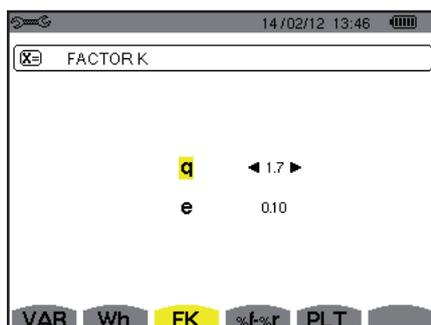
Figura 22: el menú Selección de los coeficientes de cálculo del factor
