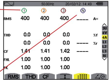
Columna de los valores RMS y (si el sensor de corriente lo permite) DC así como el CF y THD (%r) relativos al neutro.
