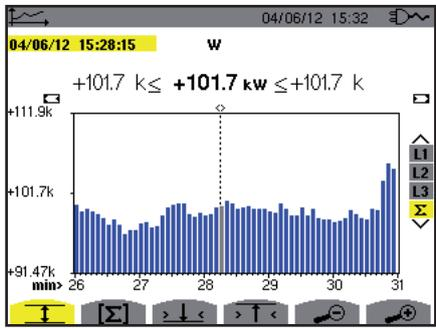
Figura 100 W ( $\Sigma$ ) con MIN-AVG-MAX
