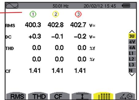
Figura 78: la pantalla de visualización simultánea en 3U
