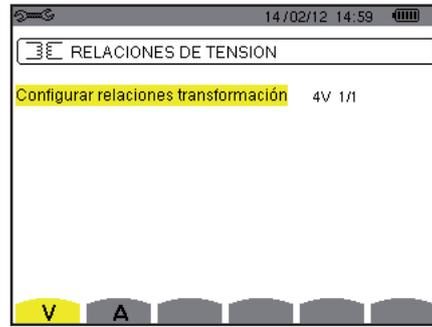
Figura 27: la pantalla Ratios de tensión en el menú Sensor y ratios en el caso de un montaje con neutro
