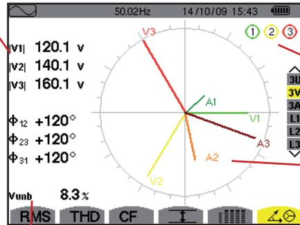
Discos de indicación de saturación potencial de canal.
