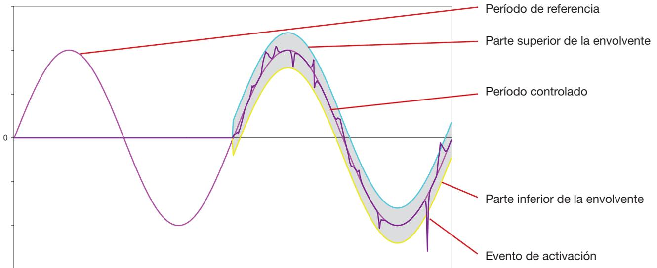
La mitad de la anchura de la envolvente para la tensión y la corriente iguala el umbral programado en el modo Transitorio de la configuración (véase § 4.8).
