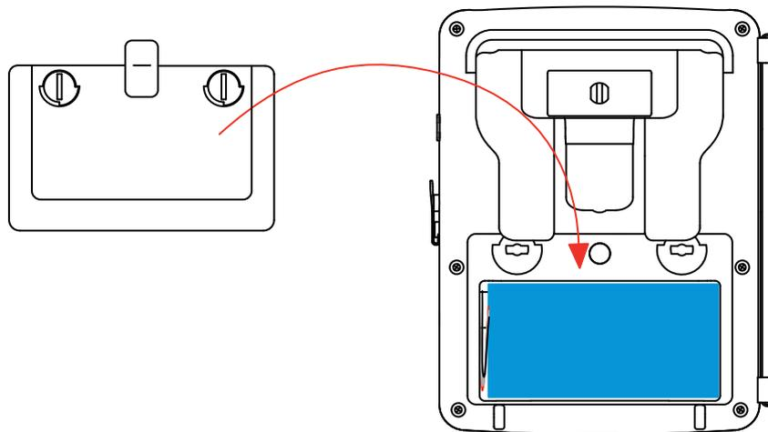
**Atención:** En el caso de que se haya desconectado la batería, aunque no haya sido cambiada, es imprescindible proceder a una recarga completa. Esto para permitir al instrumento conocer el estado de carga de la batería (información que se pierde al desconectarla).
