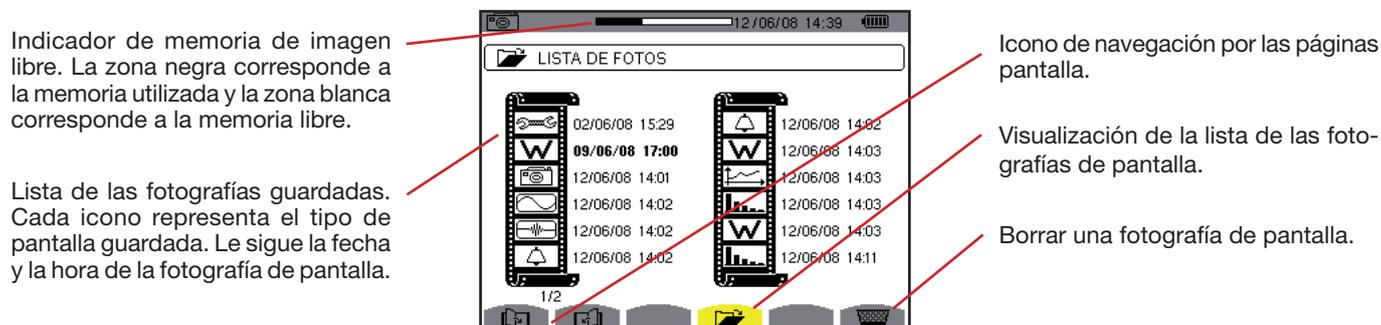
Figura 120: la pantalla de visualización de la lista de las instantáneas
